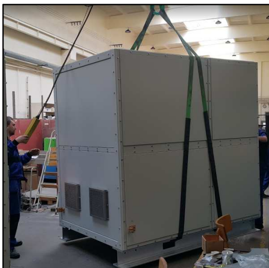
Examples of lashing and lifting the switchboard cabinets Příklady vázání a zvedání rozváděčů
